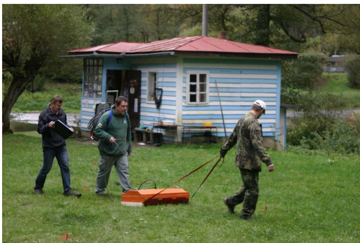
Standardní radarová metoda (GPR), která je založena na sledování odrazů radarových vln na citlivých rozhraních.
