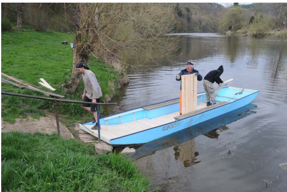
Instalace nových podlážek na dno lodi
